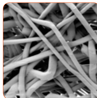
Struttura interna cartuccia Internal structure of the cartridge (100 µm)
